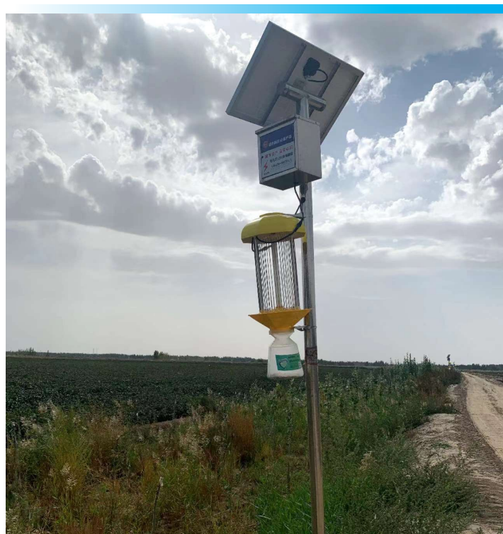
Una trampa para insectos que utiliza energía solar para analizar la variedad y cantidad de insectos, con el propósito de tomar decisiones de productos químicos razonables y controlados como corresponde.
