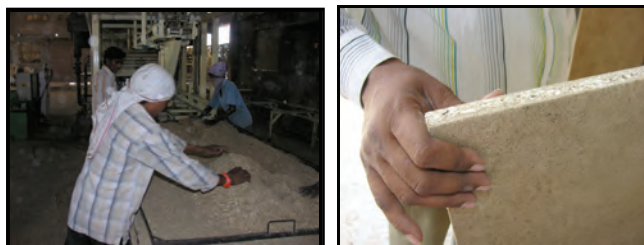
Figura 4 Preparación de tableros de partículas en la planta de tableros de partículas M/s. Godavari, India
